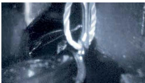
Loop Control™针对针杆和挑线槽边缘的形状进行了改进，
